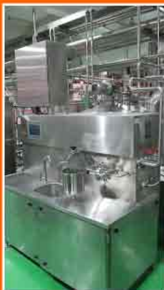
實驗型UHT設備進行製樣
