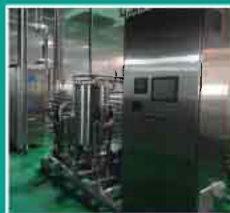
■ UHT高溫殺菌——全自動化控制系統及參數設定
