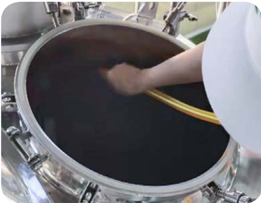
② 趕料後，使用軟化水對雙號冷卻罐進行沖洗，同時灌裝機制程灌裝的動作，將管道裏的水抽走排入下水道（同時帶走管道中的殘留物料）。
