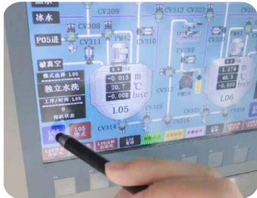
④ 點擊獨立清洗按鈕，進行對冷卻罐清洗消毒。清洗乾淨後，放 85℃ 以上的工藝熱水對灌裝機進行清洗消毒。
