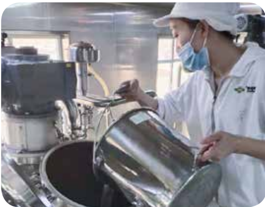
① 使用 85℃ 以上的工藝熱水對灌裝管路進行趕料。
